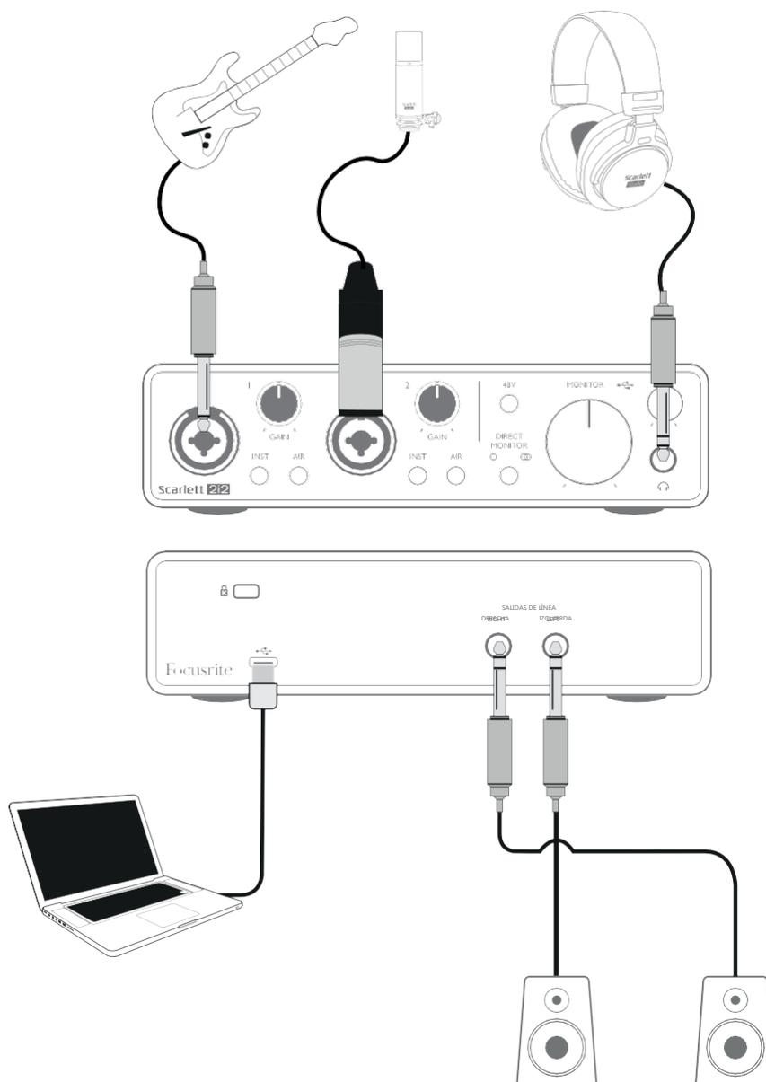
Esta configuración típica muestra las conexiones para grabar con la aplicación DAW en su Mac o PC (computadora). En este caso es posible grabar la guitarra a través de la Entrada 1 y la voz a través de la Entrada 2 en su DAW, mientras monitoriza la reproducción desde DAW a través de los auriculares (o altavoces).
