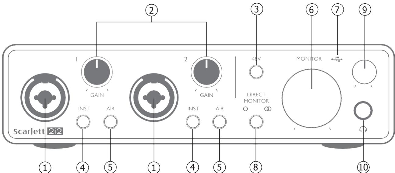
El panel frontal incluye conectores de entrada para señales de micrófono, línea e instrumentos, conector para auriculares y controles de ganancia de entrada y monitorización.
