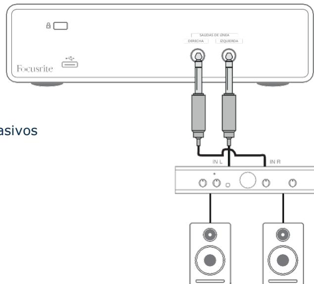
Todos los jacks(conectores) de salida de línea son TRS de 1/4" (6,35 mm) de 3 polos y están balanceados electrónicamente. Los amplificadores típicos (Hi-Fi) Alta definición y pequeños monitores activos poseen entradas no balanceadas, por medio de conectores phono (RCA) o por medio de jacks(conectores) estéreo de 3,5 mm de 3 polos, destinadas a su conexión directa en un ordenador. En cualquier caso, utilice un cable de conexión adecuado con los conectores plug en un extremo.
